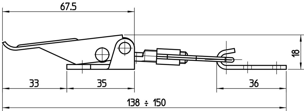
N°3 fori di fissaggio Ø5.2
